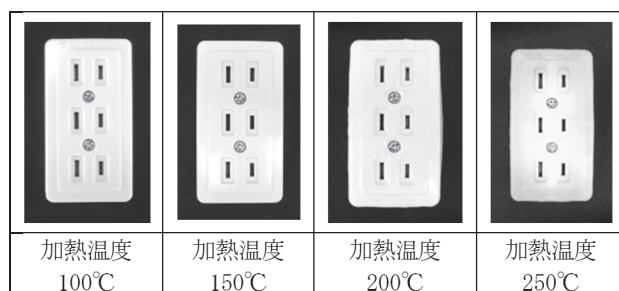
図9 恒温槽実験によるコンセントEの熱的変化
