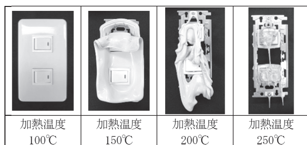
図11 恒温槽実験によるスイッチAの熱的変化
