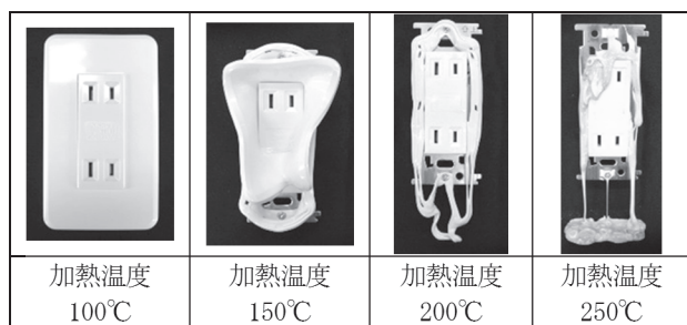
図8 恒温槽実験によるコンセントDの熱的変化
