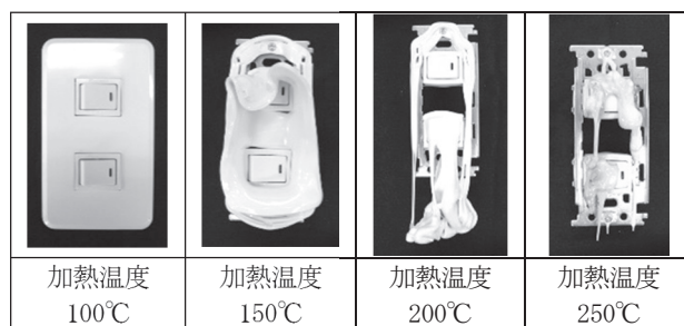
図13 恒温槽実験によるスイッチCの熱的変化
