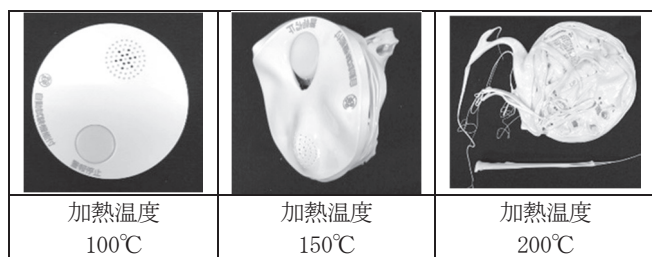
図 16 恒温槽実験による火災感知器 A の熱的变化 (天井設置)
