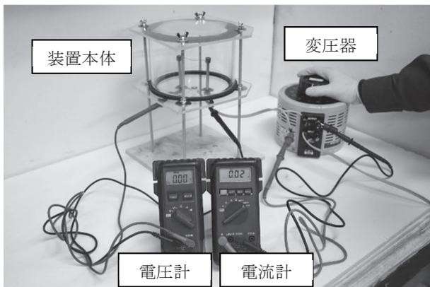
図3 電熱線着火実験装置全体図
