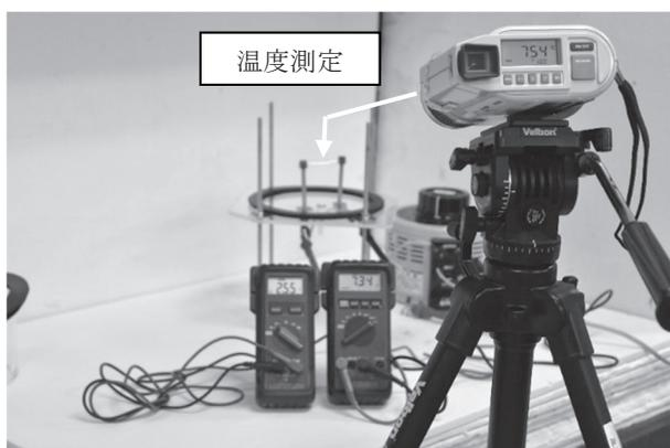
図5 電熱線温度測定実験の様子
