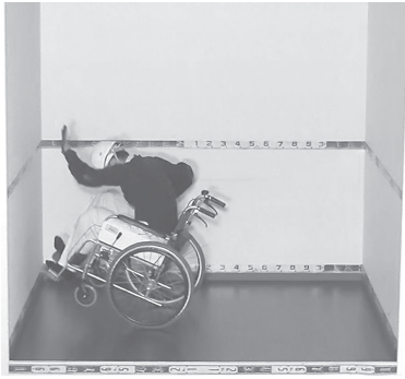
図 22 車イスがロッキングした様子
