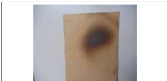
図 13 実験後の段ボール片の状況
