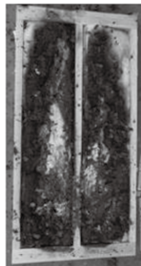
写真9 外装材取り外し 実験No. 13 枠組工法
