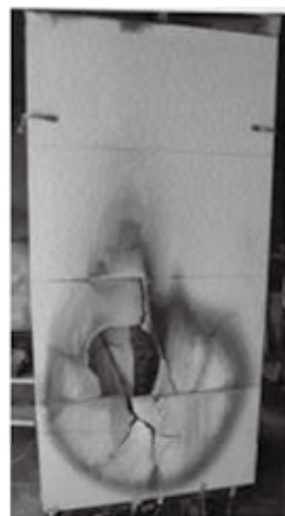
写真13 試験体の様子 実験No. 16 縦目地なし
