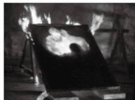
写真 36 パネルへの火炎曝露
