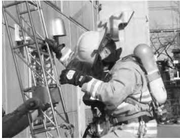
写真1 登梯時にNFPAの防火帽が離脱した例
