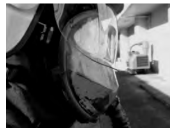
写真2 面体とシールドの干渉
