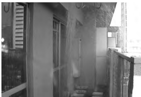
写真4 ベランダの放水状況
