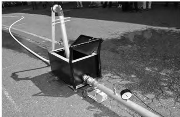
写真7 スタンドパイプ及び模擬消火栓
