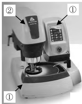
写真 4 自動研磨装置外観
