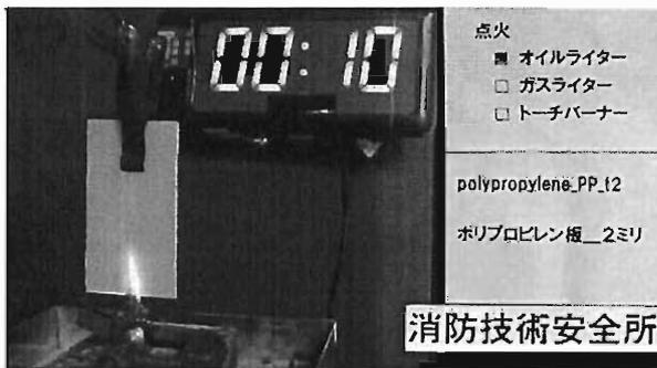
写真1 小規模試験状況 (ポリプロピレン板\_2ミリ)
