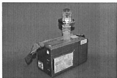
写真9 粉塵を採取する状態
