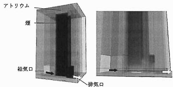
図 5 アトリウム給気前 (FDS) 図 6 アトリウム給気後 (FDS)
