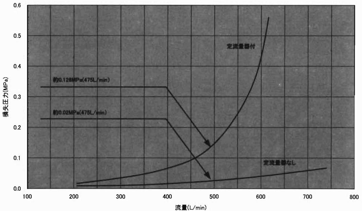
図6 分岐用媒介金具の損失圧力
