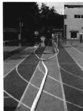
写真3 ノズル保持力測定実験②実験風景
