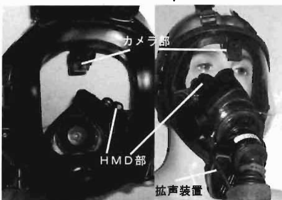
写真3 面体内外部の状況
