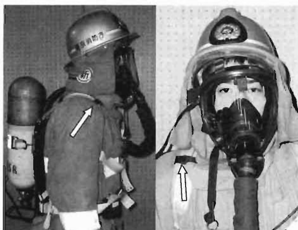
写真4 温度センサ取り付け位置及び装着状況
