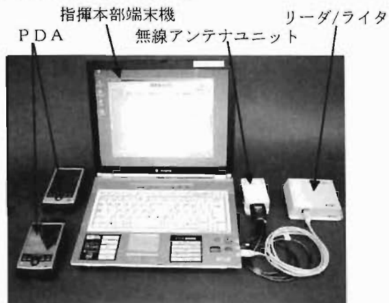
写真1 進入管理装置
