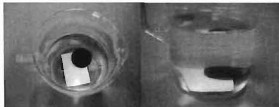
写真17 ビーカー内の水に浸したICタグ
