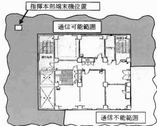
図4 訓練棟外周部の地上部分での無線通信範囲
