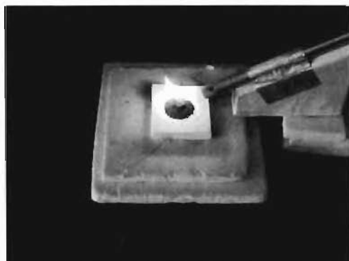
図1.2 小ガス炎着火試験の様子
