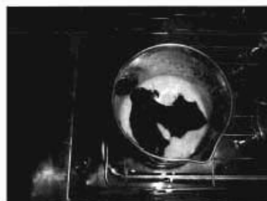
写真2 燃料により泡消火薬剤が消泡する様子
