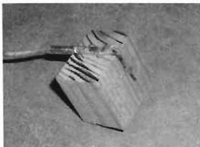
写真8 木材に熱電対を取り付けた状況
