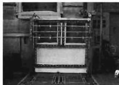
写真2 試験枠（非加熱側）
