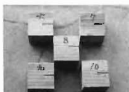
写真 26 標準試験体Cに取り付けた木材(加熱後)
