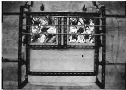
写真11 試験枠を試験炉に取り付けた状況
