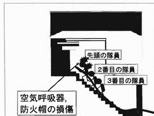
図2 火災室への進入隊形
