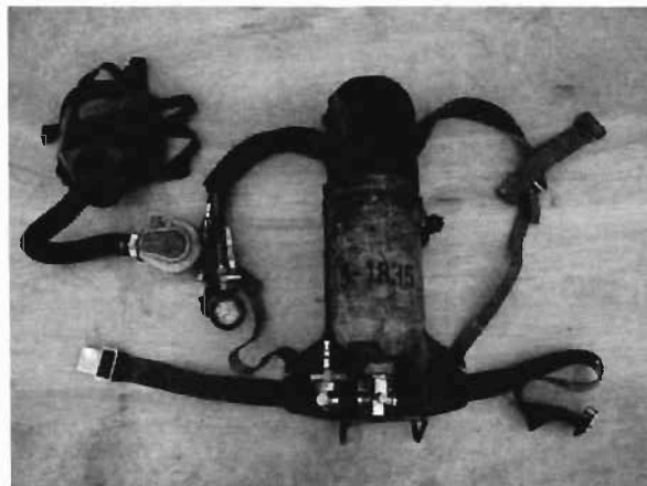
a) 空気呼吸器の損傷状況
