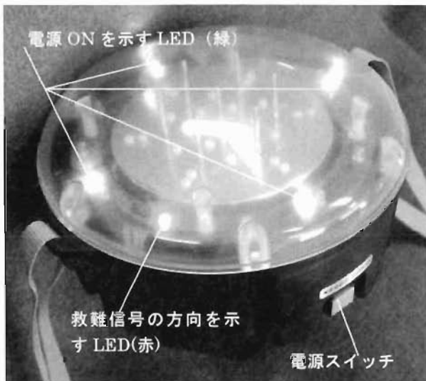
写真3 探索装置外観及び名称（上部）
