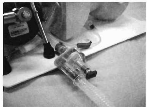
写真3 圧限定バルブのリーク口
