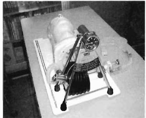
写真2 ベース人形の肺の部分はずし、 モデル肺を取り付けた
