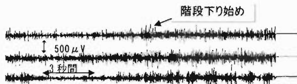
図 23 2 名で搬送中の腰部及び上腕部筋電図 (波形の位置は図 21 と同じ)
