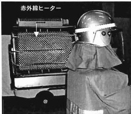
写真1 熱防護試験装置
