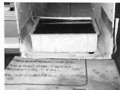
写真4 風洞内に海水上に原油を入れた容器を設置
