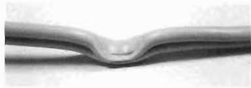
写真8 試験体1(縦置き)の状況(荷重6kg)
