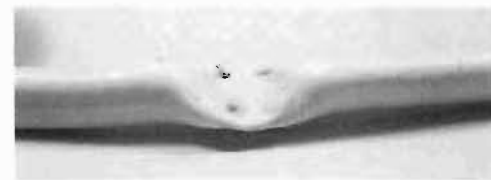
写真11 試験体4(縦置き)の状況(荷重6kg)
