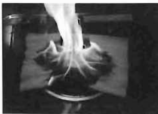
写真 23 電源遮断から 40 秒後、着火した状況
