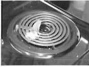
写真 6 電源遮断から 40 秒後、着火した状況
