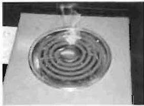
写真 19 電源遮断から 30 秒後、炭化した状況
