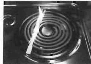
写真 15 電源遮断から 20 秒後、着火した状況
