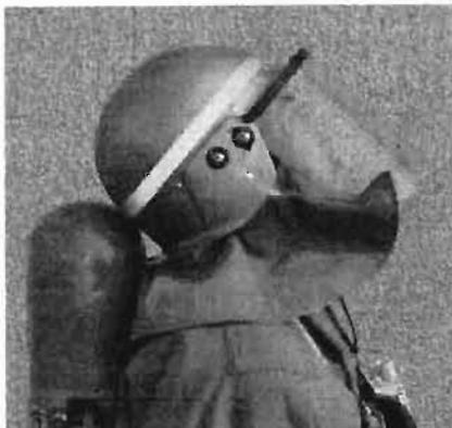
写真8 ポンベとの接触状況
