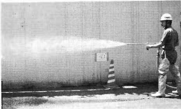
写真3 供試ノズルNo.1による放水
