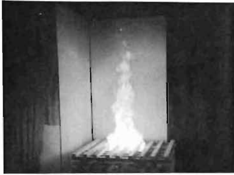
写真6 実験2の放水前の状況
