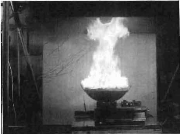
写真2 厨房火災実験の状況
