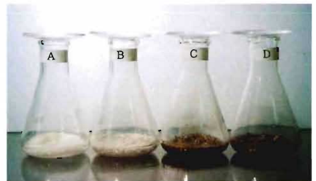
写真9 硝酸を加えた吸収剤から赤褐色の窒素酸化物が発生するか否かを確認している状況。 吸収剤A～D（パーライト及びバーミキュライト）は赤褐色のガスが発生しない。
