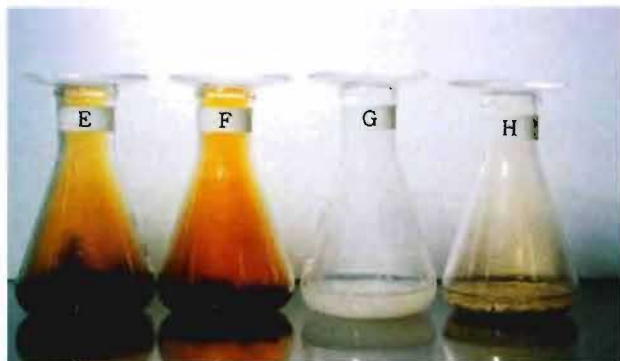
写真10 硝酸を加えた吸収剤から赤褐色の窒素酸化物が発生するか否かを確認している状況。 吸収剤E、F（活性炭）からは濃い赤褐色のガスが発生した。吸収剤H（活性白土）からは若干の赤褐色のガスが発生した。吸収剤G（ホワイトカーボン）からは赤褐色のガスは発生しない。
