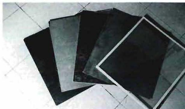
写真7 試料（左から普通ガラス・制振塗料・鉛シート・制振シート・鉄板・二重ガラス）
