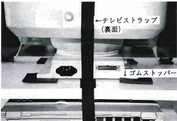
写真13 テレビストラップ及びゴムストッパーの設置状況
