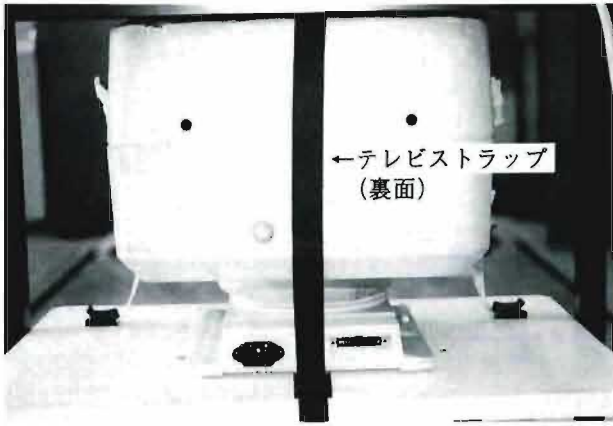
写真12 テレビストラップ (裏面) の設置状況
