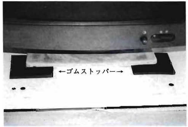
写真9 ゴムストッパーの設置状況
