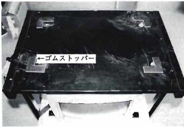
写真6 ゴムストッパーの設置状況
