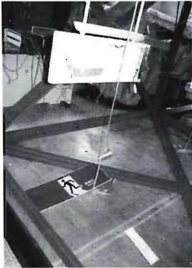
写真4 パネルとバッテリーが落下した状況
