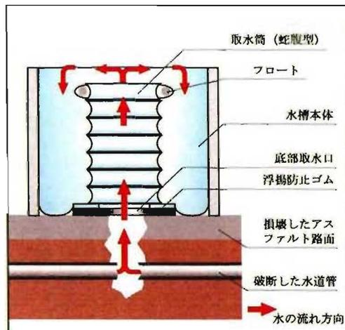
図5 改良器（取水筒蛇腹型）の構造
