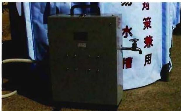
写真10 無動力式浄水器
