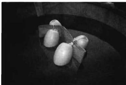
写真8 押し潰された取水筒の様子
