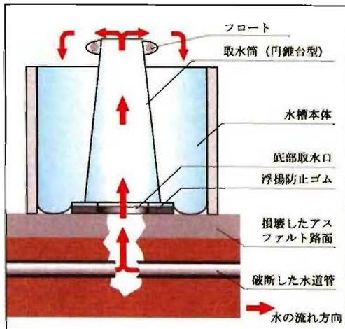
図4 改良器（取水筒円錐台型）の構造
