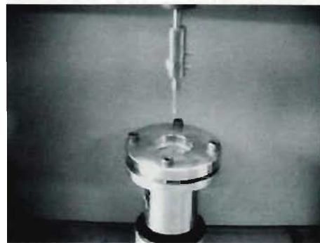
写真 1-4 突き刺し試験の状況
