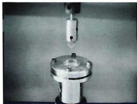
写真 1-5 耐切創性試験の状況
