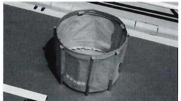
写真1 震災対策兼用簡易水槽1/4模型
