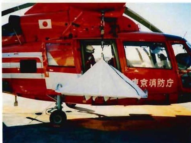
写真1 試作した担架（実験機）
