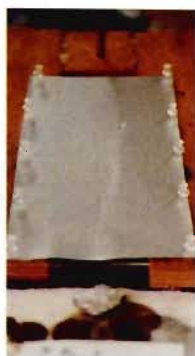
写真 5 - 1 現用防火服地 (新品、15度)
