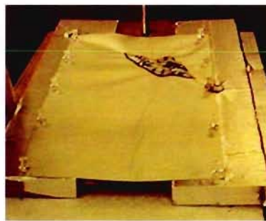
写真13-2 現用防火服地 (使用品、5度)
