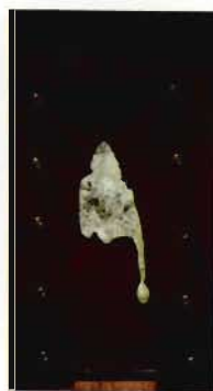
写真 2 - 2 新型防火服地 (新品、60度)
