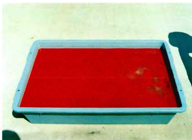
写真4 着色ガソリンの浮遊状況
