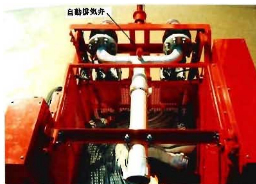
写真9 自動二又分岐（改良後）
