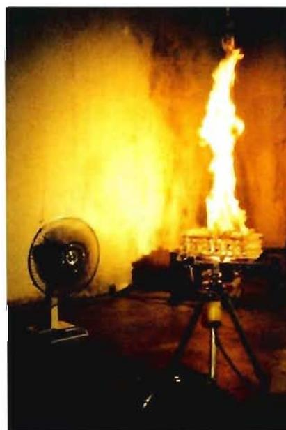
写真4 扇風機と燃烧音の測定状況
