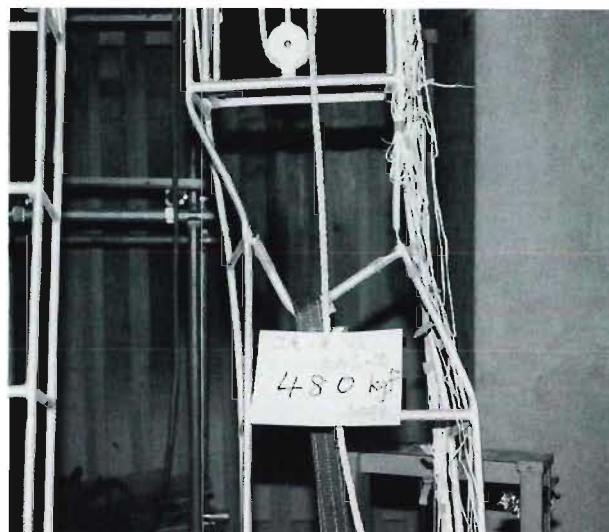
写真2 75度架てい静ひずみ測定実験 (一連目が大変形した状況)
