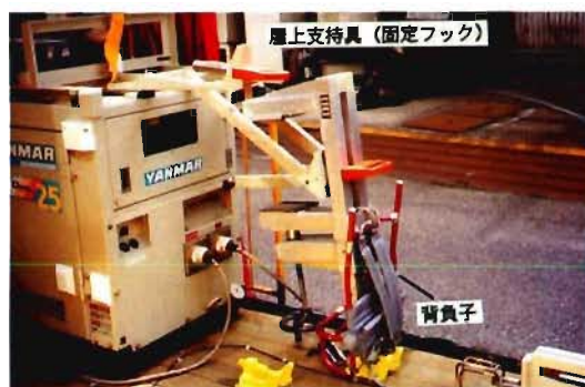
写真8 屋上支持具の収納状況
