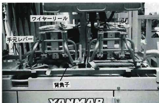
写真6 ワイヤーロープの積載状況
