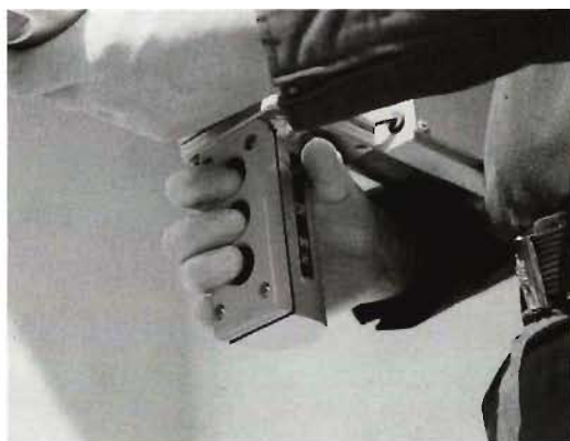
写真4 遠隔制御スイッチ
