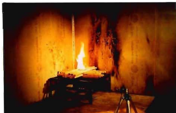
写真3 クリブの燃焼状況
