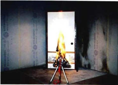
写真3 和襖の燃焼音の測定状況
