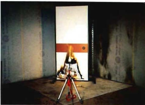
写真4 段ボール襖の燃焼音の測定状況
