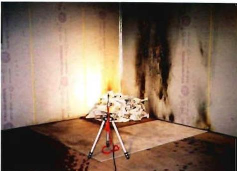
写真5 紙の燃焼音の測定状況
