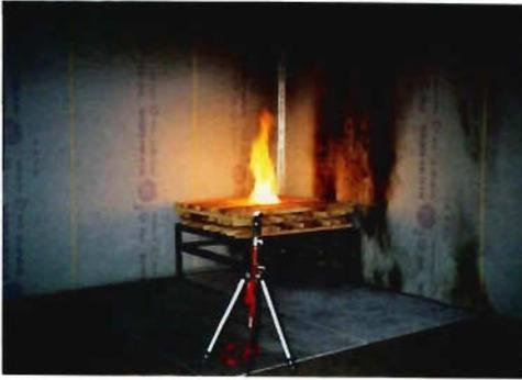
写真2 クリブの燃焼音の測定状況
