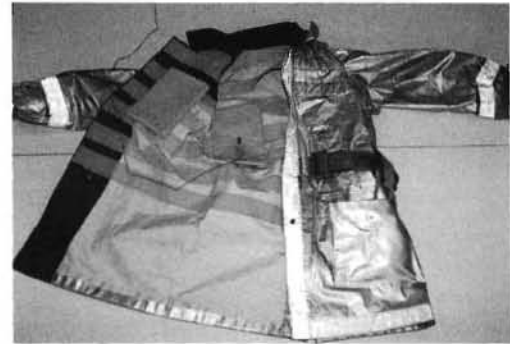
写真6 温度センサーの取付状況 (収納袋)
