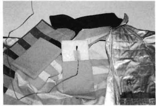
写真5 温度センサーの取付状況 (冷却材)
